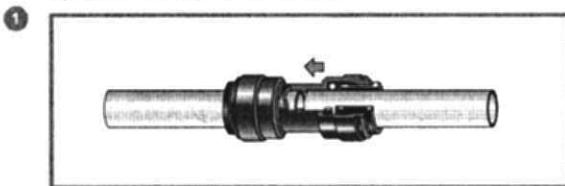
Trubku zastrčí až na doraz. Príderný prvok drží trubku pevne v spojke. O-kružkom vzniká úplne tesný spoj.
